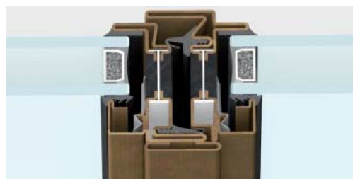
nodo centrale | sezione in vista 62 mm
