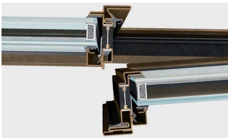
nodo centrale | sezione in vista 62 mm
